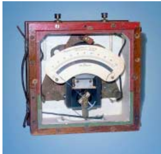
SLIKA: Levo: Princip:delovanja inštrumenta z vrtljivo tuljavico in trajnim magnetom. Desno: D'Arsonvalov milivoltmeter s permanentnim magnetom in spiralno vzmetjo več: http://physics.unl.edu/outreach/histinstr/electric.html ).
