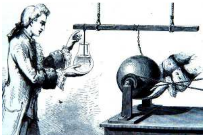
SLIKA: Primer eksperimentov v zgodovini: Na desni preprost elektrostatični generator (ročno gnana steklena krogla, naboj se ločuje z roko, ki na eni strani trsa ob kroglo, na drugi strani pa drži prevodno verigo).
