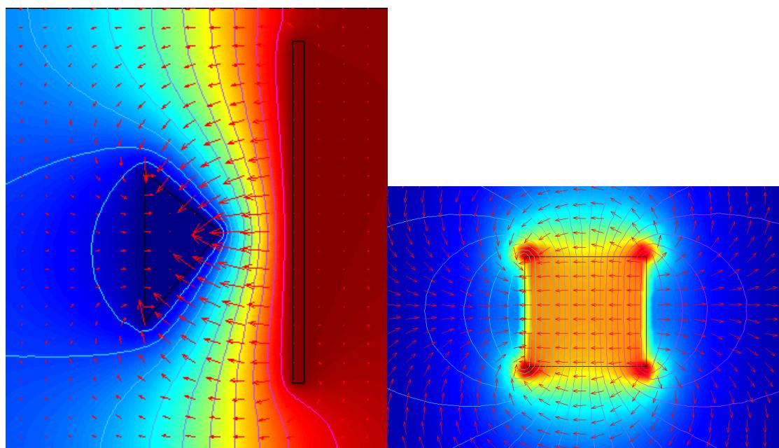
**SLIKA:** Električna poljska jakost kaže smer in hitrost upadanja potenciala. Primera polja klinaste elektrode ob ravni elektrodi in polja med ravnima ploščama. Na levi sliki so poljeg vektorjev polja prikazane še ekvipotencialne ravnine ter potencial v barvni lestvici. Na desni sliki pa so zaradi lažjega opazovanja vektorji polja normirani, velikost polja pa prikazuje barvna lestvica. Poleg tega so prikazane ekvipotencialne ravnine.
