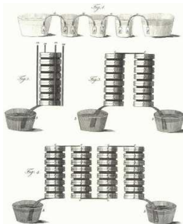
SLIKA: Voltine šalčke z elektrolitom in različnima elektrodama ter Voltina kaskada.
