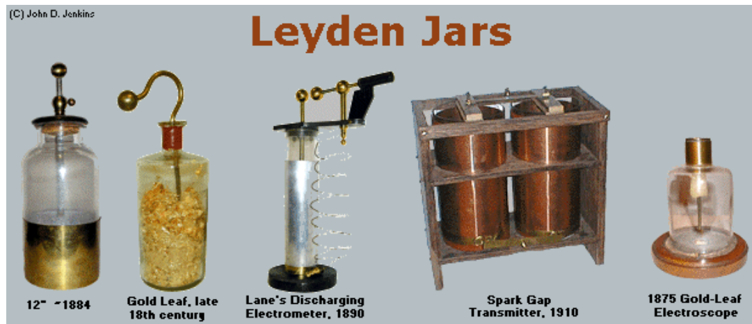
SLIKA: Primer Leidenskih flaš. Desno elektroskop.
