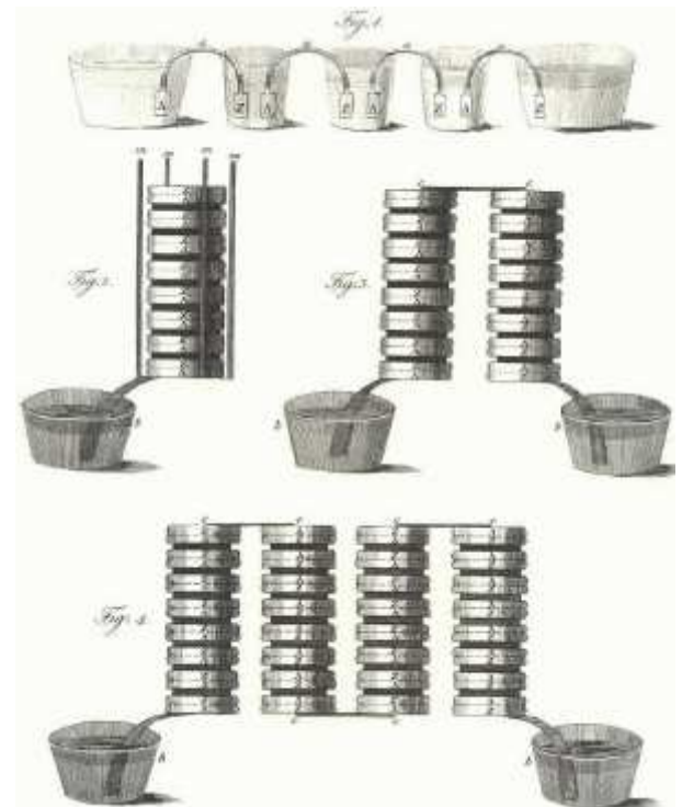
SLIKA: Voltine šalčke z elektrolitom in različnima elektrodama ter Voltina kaskada.
