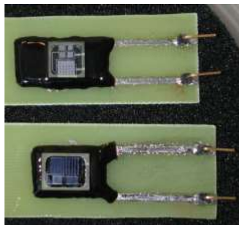
Slika 17-11: Manipulacija bioloških celic z električnim poljem. Celice se koncentrirajo na mestu najmanjšega polja, ki je v sredini in na površini elektrod. Razdalja med elektrodama je 50 \mu\text{m} . Na desni sta prikazana modula z izdelanimi mikrostrukturami. Mikrostrukture so izdelane s polprevodniško tehnologijo na pyrex steklu z dvoslojno metalizacijo.
