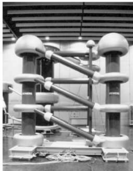
Slika 19-2: Levo: kaskadno vezje za zvišanje napetosti, tipična uporaba do 200 kV. Desno: Cockroft-Waltonov CD generator na ETH (Švica) 900kV/10 MA.
