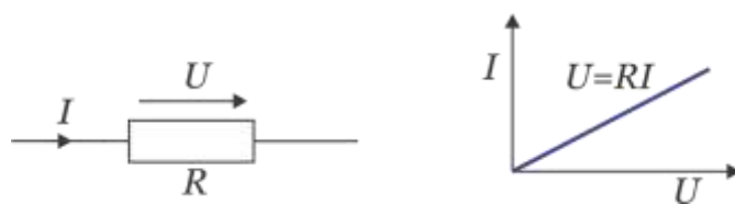
Slika 22-3: Levo: tok in napetost na upor; Desno: grafično prikazana karakteristika upora.
