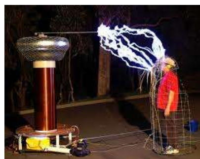
Slika 10-4: Polje znotraj luknje v lprevodniku je enako nič. Tako strukturo pogosto imenujemo Faradayeva kletka in je popularen rekvizit za prikazovanju električnih eksperimentov. Uspešno ščiti notranjost kletke pred zunanjim elektrostatičnim poljem pa tudi dinamičnem (elektromagnetnim), če je le valovna dolžina elektromagnetnega polja večja od širine odprtin. Ne more pa Faradayeva kletka ščititi pred magnetostatičnim poljem ali magnetnim poljem nizkih frekvenc. Več o tem v drugem semestru. Več: http://teslardownunder.com/
