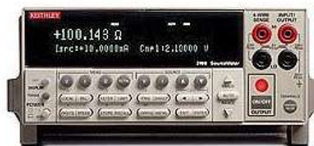
Slika 23-22: Tabela različnih tipov Source-metrov (SMU) podjetja Keithley, ki se razlikujejo po izhodni moči ter merilih območjih. V insertu desno spodaj je prikazan inštrument Keithley 2400. www.keithley.com
