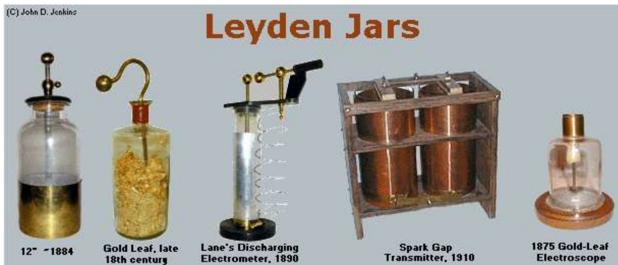
Slika 19-4: Levo so trije primeri Leidenskih steklenic. Četrti z leve je primer inštrument na podlagi Leidenske steklenice, za uporabo kot oddajnik. Desno je primer elektroskopa.
