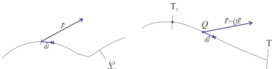
Slika 8-2: Levo: sila na poti = delo. Desno: delo električnih sil na poti od točke T_1 do T_2 .
