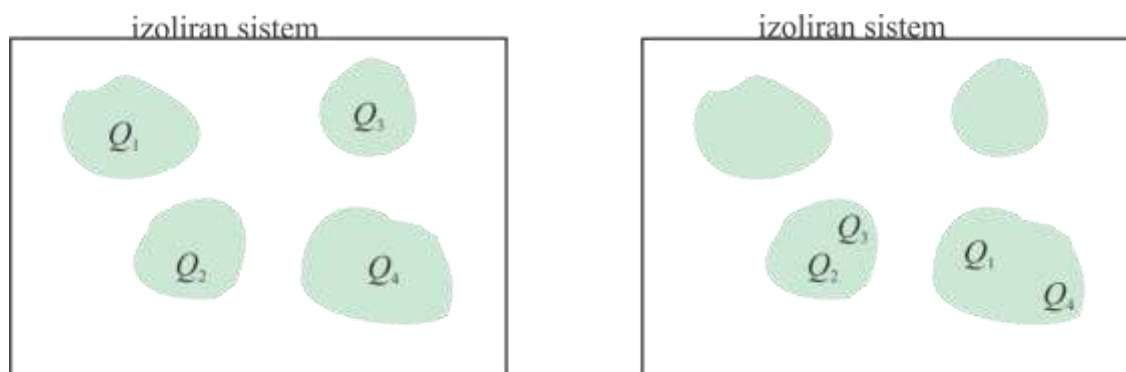
Slika 1-1: Sistem izoliranih nabojev pred (levo) in po spremembi porazdelitve naboja. Množina naboja znotraj izoliranega sistema se ne spremeni, lahko pa se prerazporeja.
