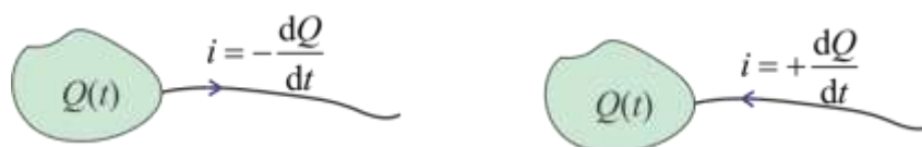
Slika 1-4: Razlaga predznaka pri zvezi med nabojem in tokom. Po definiciji je smer toka določena s pretakanjem pozitivnega naboja.
